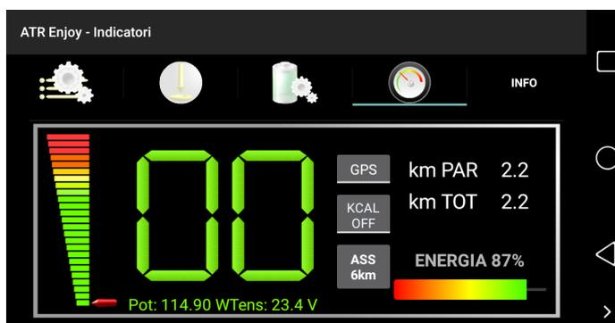
Il pannello indicatori presenta il tachimetro digitale per l'indicazione della velocità, il pulsante per l'avvio dell'assistenza a 6km/h, la barra dell'energia residua ed il conteggio delle calorie consumate che non è presente con il display in posizione orizzontale.
