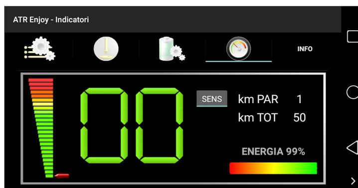
Il pannello indicatori presenta il tachimetro digitale per l'indicazione della velocità e la barra dell'energia residua.
