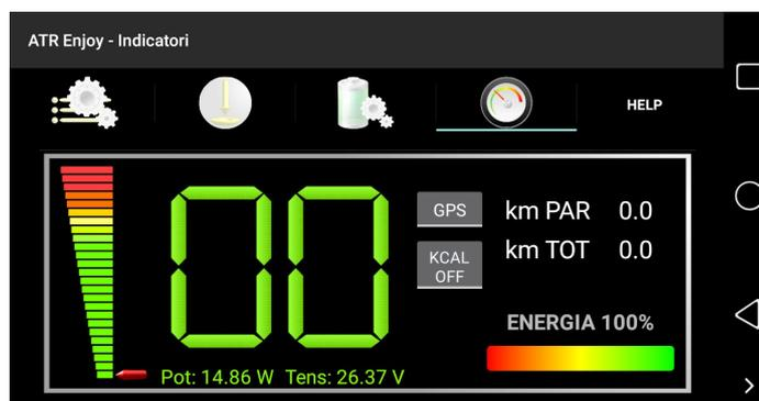
Il pannello indicatori presenta il tachimetro digitale per l'indicazione della velocità, la barra dell'energia residua ed il conteggio delle calorie.
