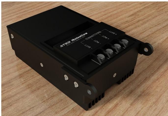
Il radiatore in alluminio anodizzato consente la dissipazione del calore prodotto da alcuni componenti elettronici. La temperatura del radiatore è rilevata e riportata nei dati di funzionamento. In caso di superamento del limite di temperatura previsto la centralina interrompe l'alimentazione al motore. I punti di fissaggio della centralina alla bici sono stati realizzati in modo perfettamente compatibile con quelli originali Aprilia.
